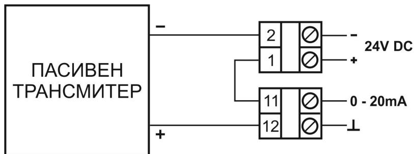
Начин на свързване на вграденият източник за захранване на токовият изход
